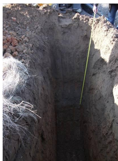
Imagem 09 – aspectos texturais dos horizontes A e B na cava PP1, vertência da água edáfica no contato entre estes horizontes.
