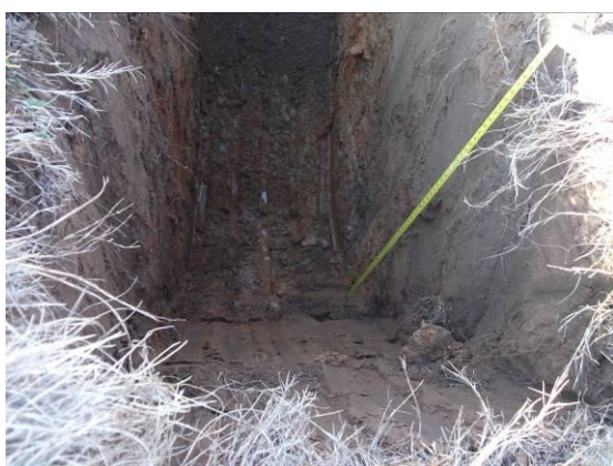
Imagem 08 – aspectos texturais dos horizontes A e B na cava PP2, e vertência da água edáfica no contato entre estes horizontes, em função da diferença nos seus coeficientes de permeabilidade.
